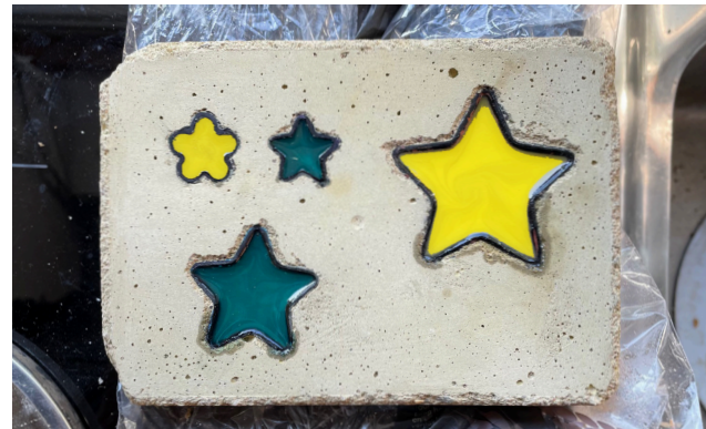
Uitsparing in het beton met inlay CNC frees tekening met pu-giethars gieting
