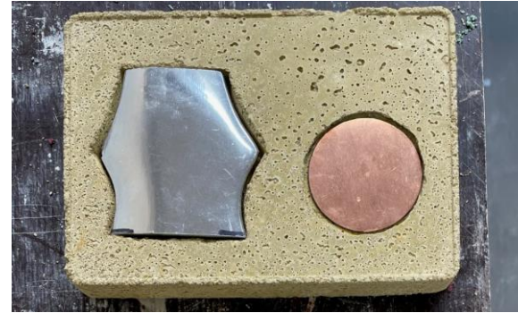
Uitsparing in het beton met CNC Frees koper inlay
